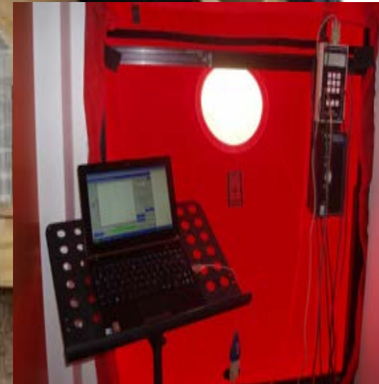
Blower door test
