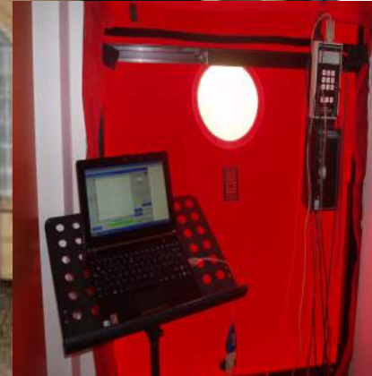
Blower door test
